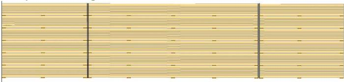
Lorsque la largeur nécessite plusieurs lames, cette technique consiste à aligner l'aboutage sur une seule ligne. Noter que lorsqu'il y a aboutage, il faut laisser un jeu pour la dilatation et mettre une **double lambourde**. Ceçi pour éviter la stagnation de l'eau et permettre de visser les lames à au moins 2 cm des extrémités
