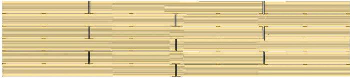
Aboutages décalés une lame sur deux, type alignement de pierres, très esthétique en veillant à respecter une symétrie dans le plan (coupes de même longueur). Par exemple 4m et 2x1.5 pour une largeur de 7m Là aussi, prévoir une **double lambourde** sur chaque ligne d'aboutage.
